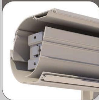
Профиль барабана изготавливается из высокопрочного экструзионного профиля алюминиевого сплава T5 6063. Профиль барабана состоит из 3 частей- профиль короб, вал/кассет для ткани и крышка. Средний вес этих профилей составляет 6100 г за метр в общей сложности.
