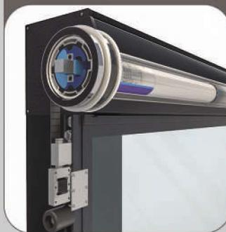
Стандартно используется электропривод марки Becker. Труба двигателя проходя через ременный шкив соединена с боковыми стеклами посредством подшипника. Таким образом, принимая нагрузку стекол от электропривода направляет к боковым несущим колоннам, этим сводит к минимуму повреждения электропривода.
