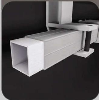
Алюминиевый основной несущий коробчатый профиль размером 43x43x1 мм, который используется в качестве стандартного профиля в локтевых выдвигаемых маркизах, прикрывая стальной профиль размером 40x40x2 мм обрезает внешний контакт стального профиля, таким образом, полностью устраняет проблему коррозии стали.
