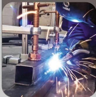
Строительный материал специальной маркизы изготавливается из корыччатого профиля, который варьируется в зависимости от размеров изделия. Используются размеры профиля от 20 x 20 мм / 40 x 40 мм до 1,50 м толщины 3 мм.
