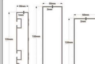
Профиль задней горизонтальной балки под козырьком серии RTS1300 имеет размер 135 мм x 30 мм. Этот профиль весит 1745гр за метр. Размер профиля торцевой связки составляет 150 мм x 50 мм. Этот профиль весит 2150гр за метр. Профиль торцевой связки размером 120 мм x 60 мм весит 1900гр за метр. Алюминий сплав T5 6063 является сырьем нашего высоколегированного экструзионного профиля.
