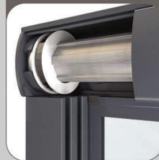
В системе остекления используется специальный триггерный ремень от итальянского производителя. Этот ремень снабжен стальной проволокой с грузоподъемностью до 500 кг. В производимой нами автоматической системе остекления ремень интегрируется в систему посредством сжатия в подшипнике и в соединительной части стеклянного модуля с помощью специального устройства. Благодаря этому способу минимизируется риск возникновения повреждений ремня.
